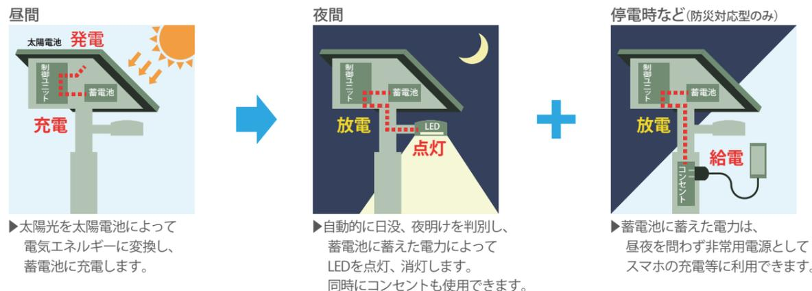
▶ 太陽光を太陽電池によって電気エネルギーに変換し、蓄電池に充電します。
