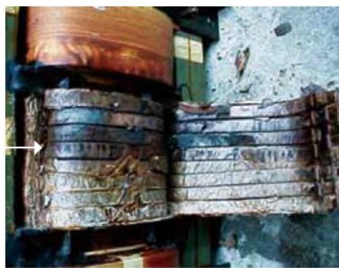
寿命・経年劣化で焼損した安定器事例
