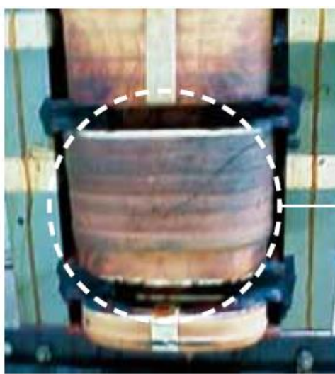
寿命・経年劣化で焼損した安定器事例
